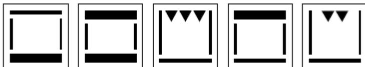
Funções clássicas utilizam calor superior e inferior, adequado para cozinhar um só prato. O alimento deve ser colocado no interior do forno somente após atingir a temperatura ajustada (após apagar o indicador luminoso de temperatura). O usuário poderá alterar a função e a temperatura para finalizar algum tipo de alimento. É aconselhável abrir o menos possível a porta do forno durante a cozedura.
