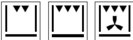
Funções com Grill, indicado para grelhados ou gratinar alimentos. Para correta utilização do Grill, posicionar a “prateleira” nas posições 1 e 2, aquecer previamente por 5 minutos. Posicionar o termostato no ajuste desejado.
